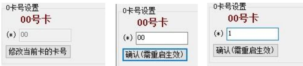
3.修改完卡号后，关闭软件，控制卡重新上电后生效。
