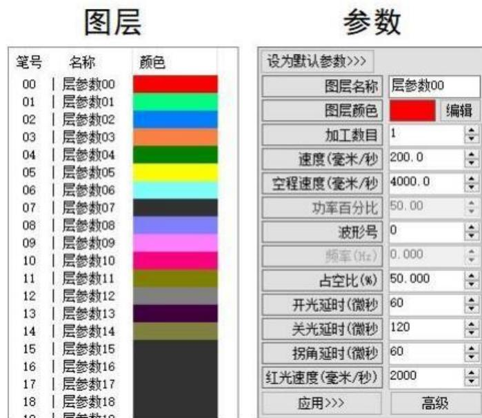
每一个图层对应一组激光参数，我们也可以在参数里面更改图层的名称和图层的颜色。点击图层的名称，参数栏会显示当前图层的图层名称、图层颜色以及图层所对应的参数数据，参数数据包含加工数目、加工速度、功率等，更改完参数后点击应用即可保存当前图层参数。
