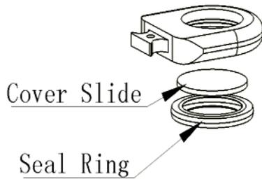
图 9 准直保护镜座结构
