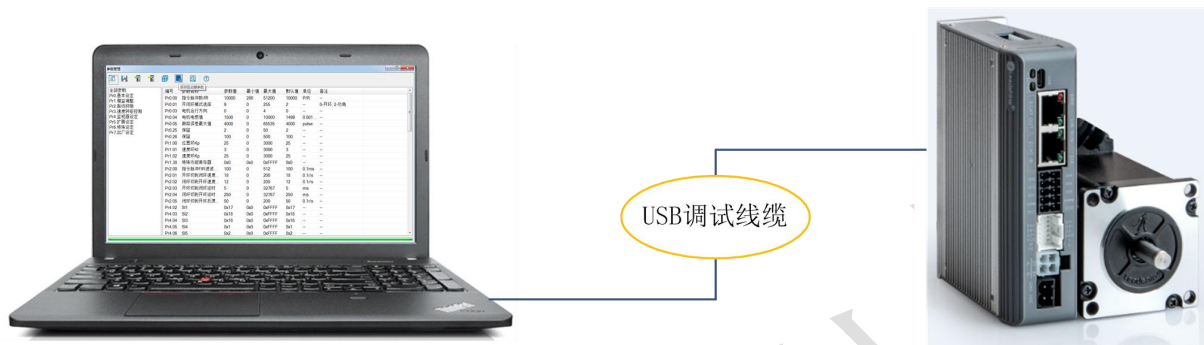
图 4-2 驱动器与 PC 的连接示意图
